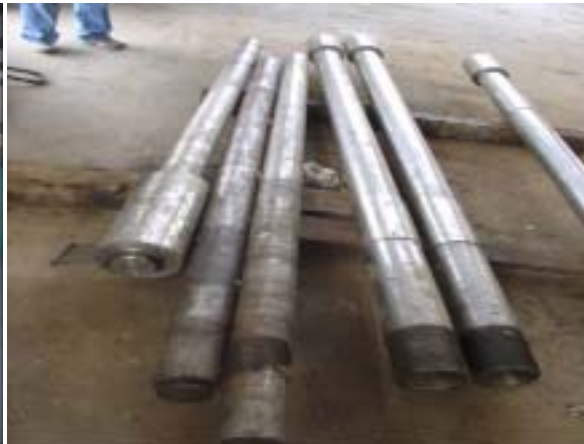
Ejes de bombas en reparación
